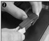
2 Rimuovere la protezione dalla testina per sostituire la puntina
