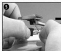
5 Sostituire con una nuova puntina, assicurarsi che i cavi audio siano montati saldamente e quindi agganciarli nuovamente al braccio del giradischi.
