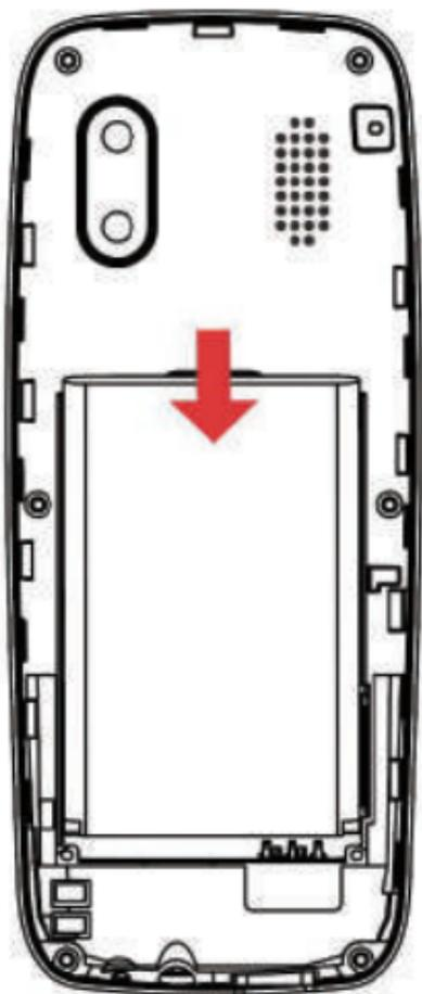
Riposizionare il coperchio della batteria, assicurandosi che si chiuda completamente.
