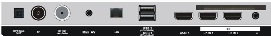
Utilizzare il cavo OTTICO (non incluso) per collegare l'unità all'amplificatore o altri dispositivi audio per l'uscita del segnale audio coassiale.
