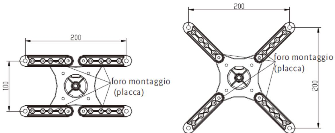
Per fissare le viti M4 e M5 allo schermo = Pour fixer les vis M4 et M5 à l'écran
