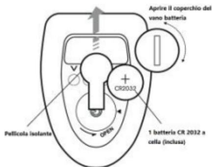
Le produit utilise une pile CR2032 pour maintenir les paramètres quand il n'est pas branché à une prise d'alimentation.
