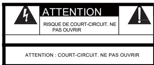
**SYMBOLE D'UN ÉCLAIR FLÉCHÉ** - dans un triangle équilatéral a pour but d'avertir l'utilisateur de la présence d'une tension dangereuse non isolée à l'intérieur de l'appareil qui pourrait être d'une amplitude telle qu'elle entraîne un risque de décharge électrique pour l'utilisateur.
