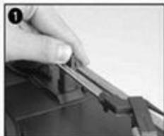
Levante la palanca de bloqueo del brazo para soltarlo.
