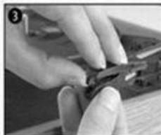
Extraiga el cabezal del brazo.
