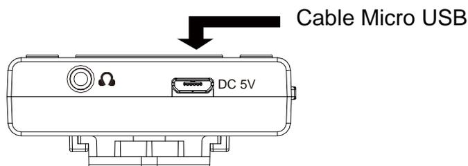
Conecte el otro extremo del cable Micro USB a la fuente de alimentación utilizando el alimentador USB. También se puede recargar el aparato conectándolo al puerto USB de una computadora.
