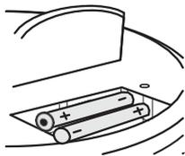
El aparato funciona con dos pilas 1,5V AA que se instalan o se reemplazan de la manera siguiente:
