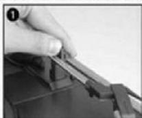
Heben Sie den Hebel zum Verriegeln des Plattenspielerarms an, um ihn zu entriegeln.
