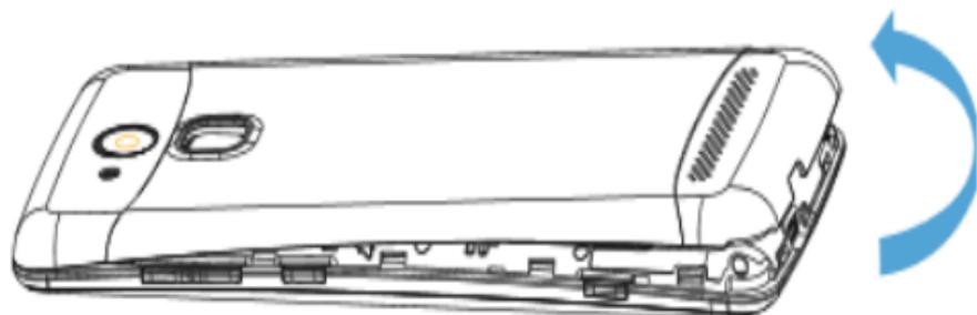
Legen Sie die Batterie unter Beachtung der Position der Kontakte in das Fach:
